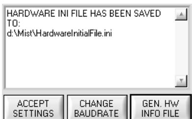
Über den Button **GEN. HW INFO FILE** wird ein File erzeugt, in dem alle wichtigen Sensordaten verschlüsselt hinterlegt werden. Dieses File kann zu Diagnosezwecke an den Hersteller gesendet werden.
